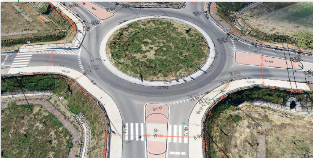
Model 3D wygenerowany na podstawie danych z drona WingtraOne z nałożonymi warstwami wektorowymi – droga S7 (węzeł Rychnowo)
