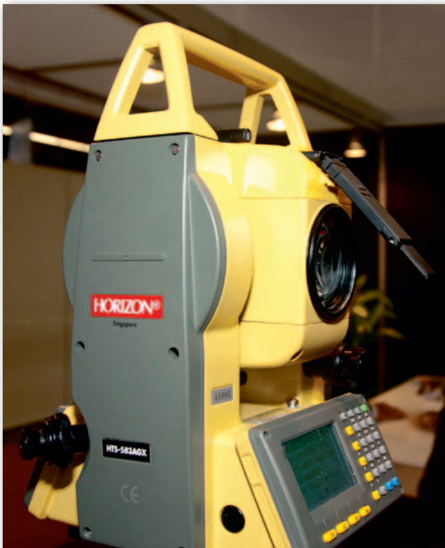
Tachimetr firmy Horizon z technologią EZHeight umożliwiającą pomiar wysokości instrumentu
