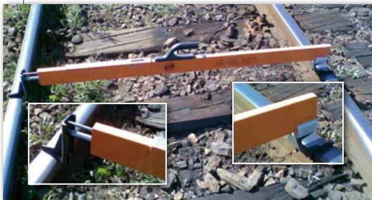
Rys 3. Ręczny toromierz elektroniczny RTE 2 firmy PROVENTUS
