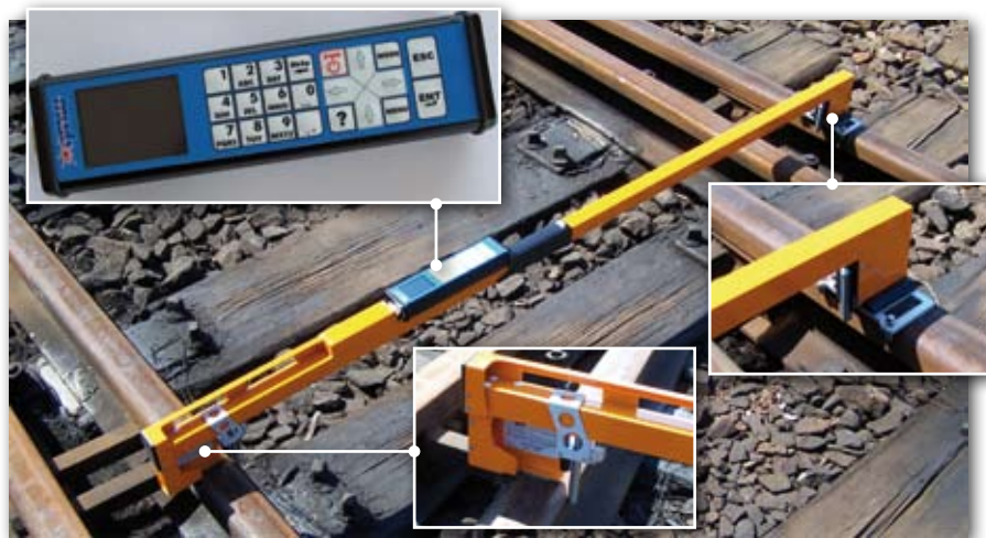
Rys 4. Podstawowe elementy toromierza DTG firmy GRAW: stopka lewa – ruchoma, stopka prawa – stała, rejestrator
