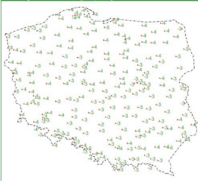
RYS. 2. WARTOŚCI RUCHÓW PIONOWYCH W WĘZŁACH SIECI [mm/rok]
