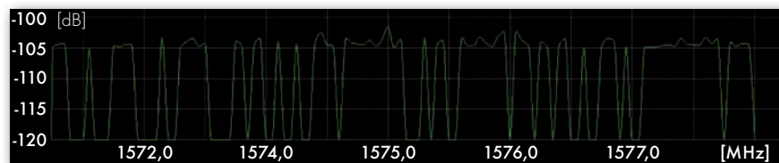
Rys. 10. Widmo sygnału L1 wraz z sygnałem zagłuszającym (moc dla danej częstotliwości)
