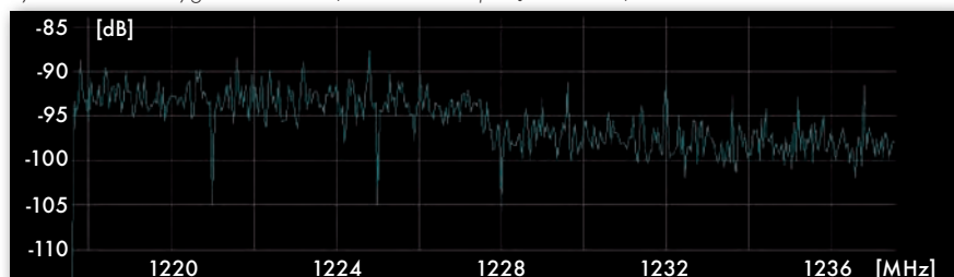
Rys. 14. Widmo sygnału GPS L2 (moc dla danej częstotliwości)
