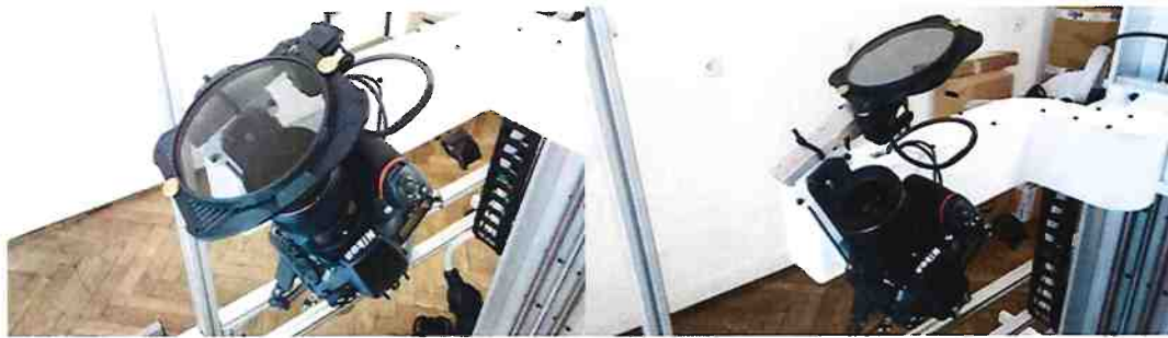
Rys. 4: System ruchomego filtra polaryzacyjnego. Źródło: wyniki badań, TERRAMAP Sp. z o.o.
