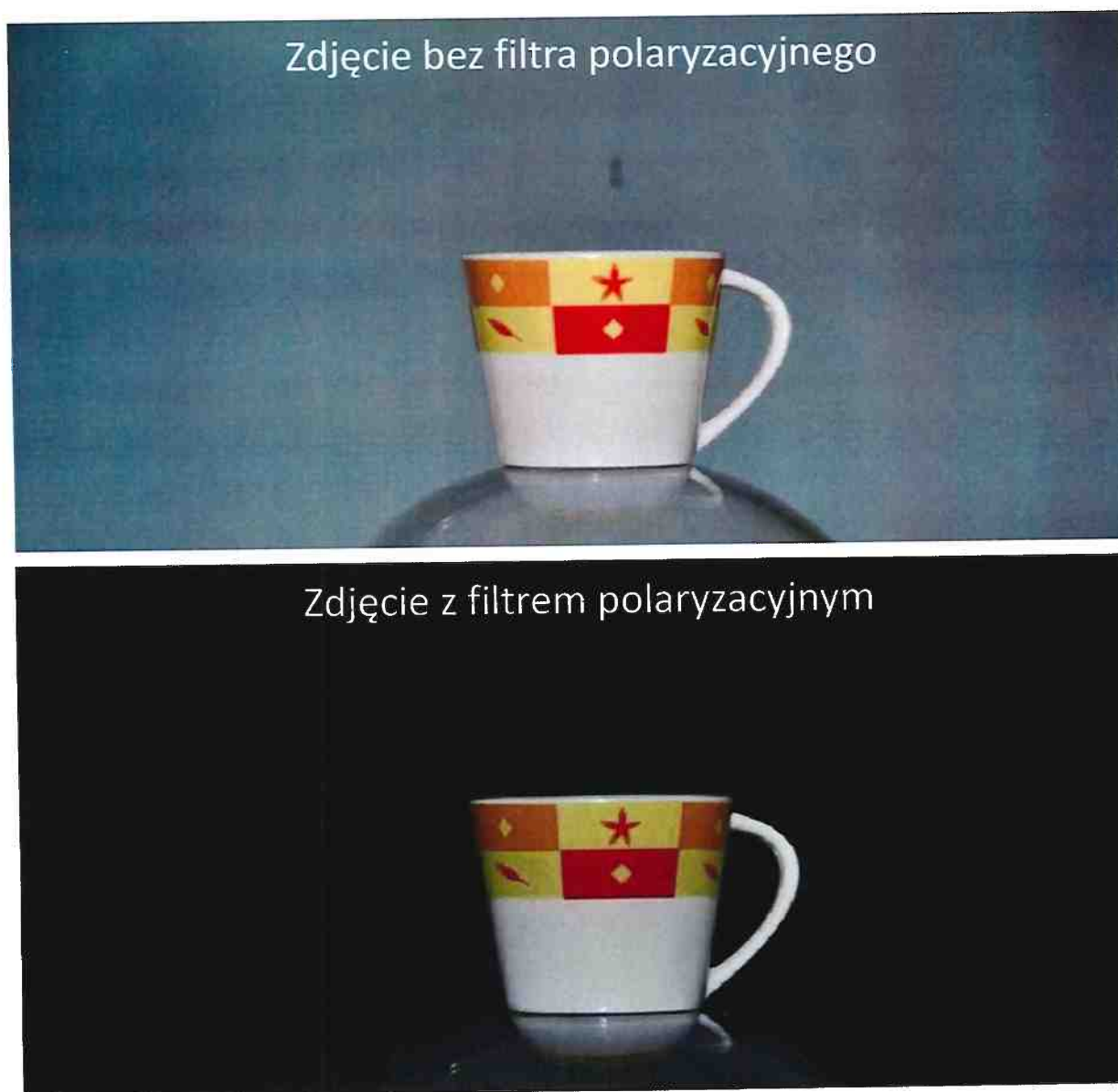
Rys. 2: Efekt wykorzystania wystania zjawiska polaryzacji. Źródło: wyniki badań, TERRAMAP Sp. z o.o.
