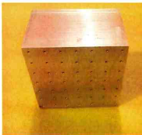
Rys. 13 Obiekt kalibracyjny i zestaw współrzędnych pozyskanych zdjęć w układzie stolika. Źródło: wyniki badań, TERRAMAP Sp. z o.o.
