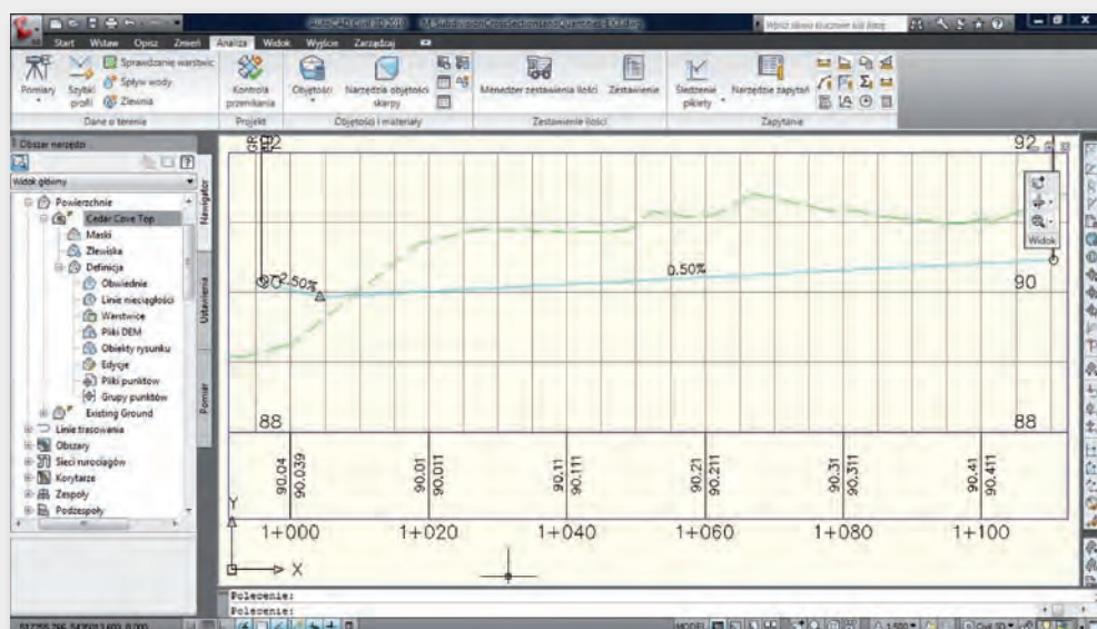
Rys. 3. Przekrój podłużny wraz z projektem sieci kanalizacji
