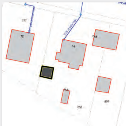
Rys. 4. Wynik działania operatora SDO_COVEREDBY
