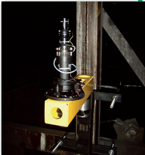
Rys. 4. Pion laserowy zamontowany na prowadniku bez obudowy
