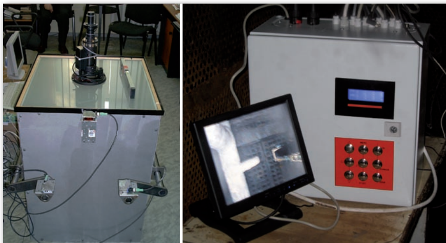
Fot. 7. System detekcyjny plamki laserowej w warunkach laboratoryjnych
