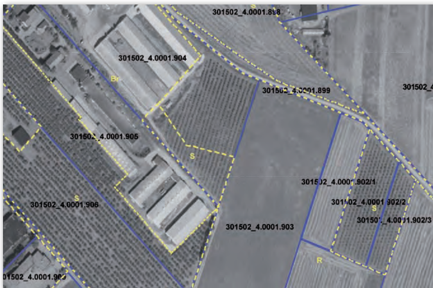
Rys. 9. Błędy weryfikacji użytków gruntowych – brak powiększenia sadu – „S”
