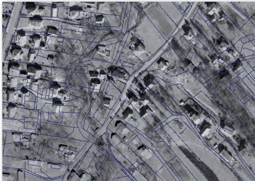
Rys. 1. Przykład kalibracji rastrów analogowych map ewidencyjnych opartych na materiałach byłego katastru austriackiego. Widoczne znaczne rozbieżności przebiegu granic działek ewidencyjnych opracowanych z map byłego katastru austriackiego (1:2880) po nałożeniu na aktualną cyfrową ortofotomapę (1:2000)
