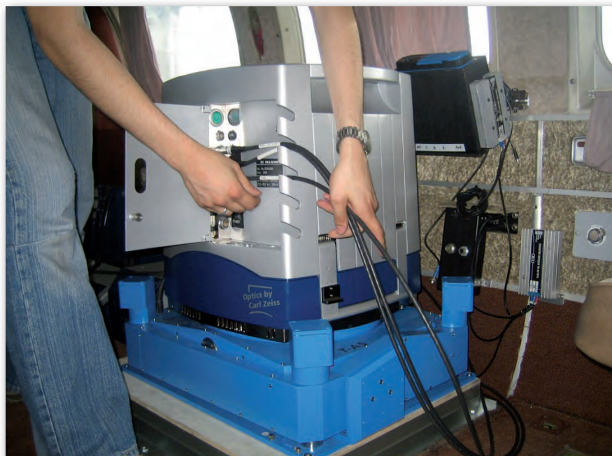
Montaż cyfrowej kamery DMC na pokładzie samolotu MGGP
