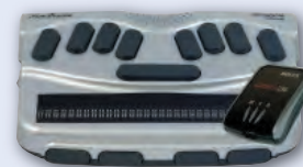
Rys. 3. Odbiornik GPS, klawiatura brajlowska oraz zastępujący ją PDA jako elementy sprzętowe zestawu nawigacyjnego Trekker
