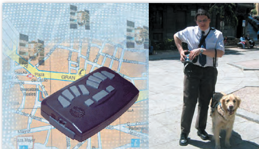
Rys. 2. Klawiatura brajlowska modułu komunikacji wykorzystana w systemie Tormes i użytkownik systemu wraz z psem przewodnikiem
