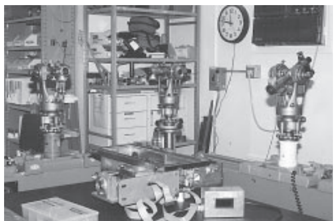
Fot. 7. Pomiar współrzędnych tłowych (metoda optyczna)
