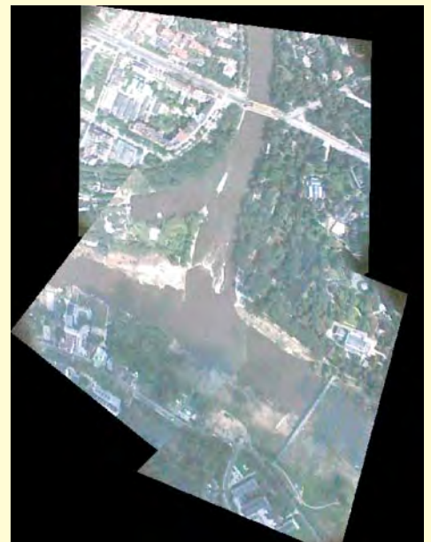
▼ Mozaika kilku kadrów zobrazowań wideo wykonanych w zakresie widzialnym, zrektyfikowanych i połączonych ze sobą przy wykorzystaniu oprogramowania Erdas Imagine. Data pozyskania zobrazowania – 30 lipca 1997 r.
