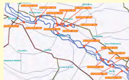
▲ Mapa zniszczeń i uszkodzeń wykonana po przelocie śmigłowca wzdłuż wałów przeciwpowodziowych na podstawie obserwacji bezpośrednich, jak również analizy zarejestrowanych materiałów wideo
