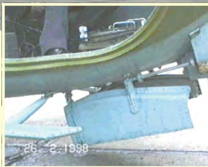
▲ Śmigłowiec Mi2-FM z widocznym otwartym lukiem technologicznym – jedyny tego typu śmigłowiec pozwalający na montaż aparatury obrazowej wewnątrz śmigłowca, co nie wymaga stosowania specjalnych wysięgników i umożliwia zmianę konfiguracji sensorów w czasie lotu
