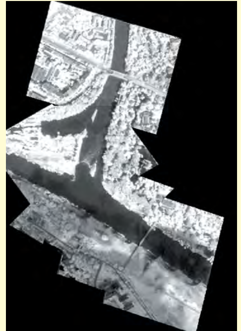
▲ Mozaika kilku kadrów zobrazowań wideo wykonanych w paśmie bliskiej podczerwieni (650-1000 nm) zrektyfikowanych i połączonych ze sobą przy wykorzystaniu oprogramowania Erdas Imagine. W ody – kolor czarny. W dolnej części zobrazowania ciemny (ale nie czarny) kolor terenu po lewej stronie Odry świadczy o tym, że woda już opadła, ale teren w dalszy ciągu jest jeszcze mokry. Data pozyskania zobrazowania – 30 lipca 1997 r.
