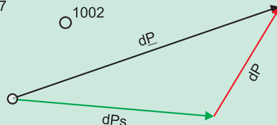
Rys. 2. Wektory lokalnych przemieszczeń punktów na koronie obwałowania
