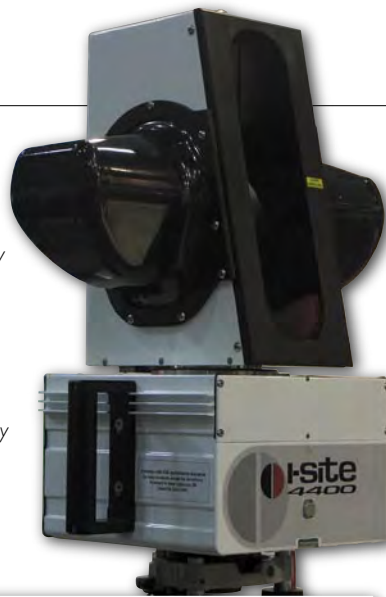
Po lewej: „Cieplutki” wyplot ortofotomapy Po prawej: Australijski skaner I-Site 4400 Poniżej: Pokaz zasady działania lasera rurowego
