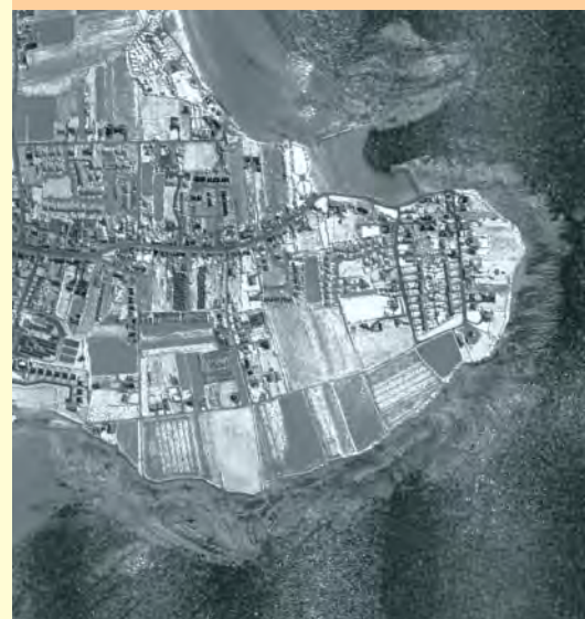
Rys. 5. DTM wygenerowany dla oceny erozji wybrzeża pokazujący rzeźbę intensywnością odbić sygnału
