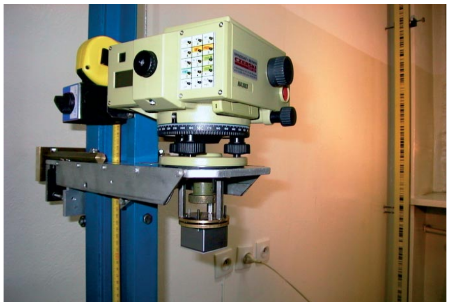
Fot. 1. Niwelator cyfrowy NA3003 firmy Leica ustawiony na przemieszczanym pionowo wózku komparatora oraz komparowana łata GPCL3 (w głębi)
