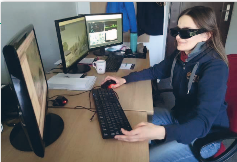
Pomiar stereoskopowy linii strukturalnych na stacji fotogrametrycznej
