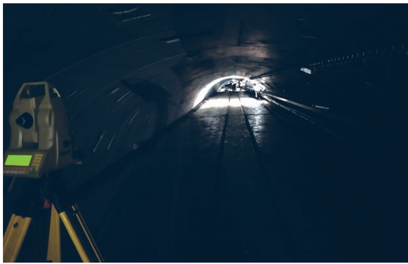
Pomiary tachymetryczne po II awarii w 2020 r. odbywały się w bardzo trudnych warunkach
