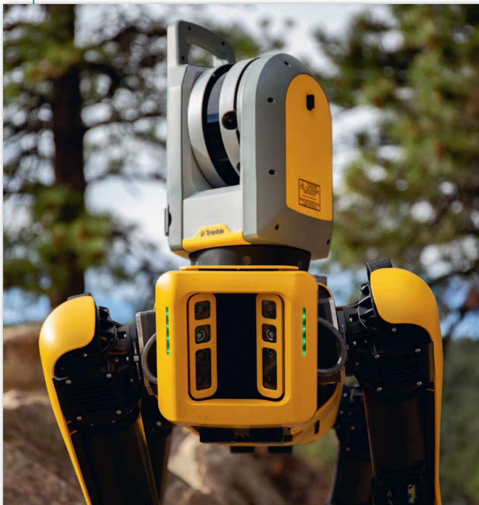
Firma Trimble bada możliwość integracji robota Spot m.in. ze skanerem laserowym
