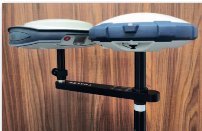
Odbiorniki SP60 i SP85 (z lewej) na jednej tycy przygotowane do pomiaru testowego
