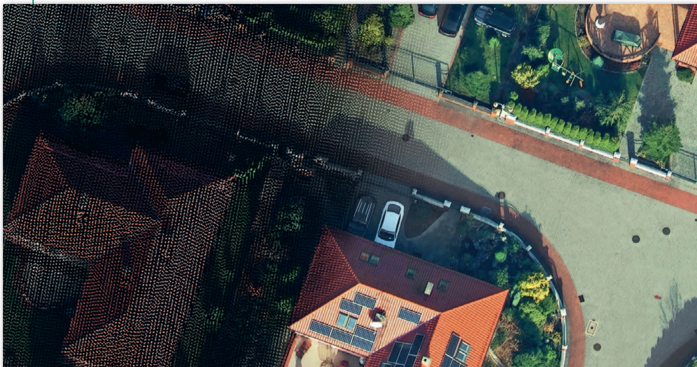
Chmura ze skanera laserowego o gęstości 12 pkt/m kw. pozyskana razem z wielkoformatowymi zdjęciami o rozdzielczości terenowej 3 cm
