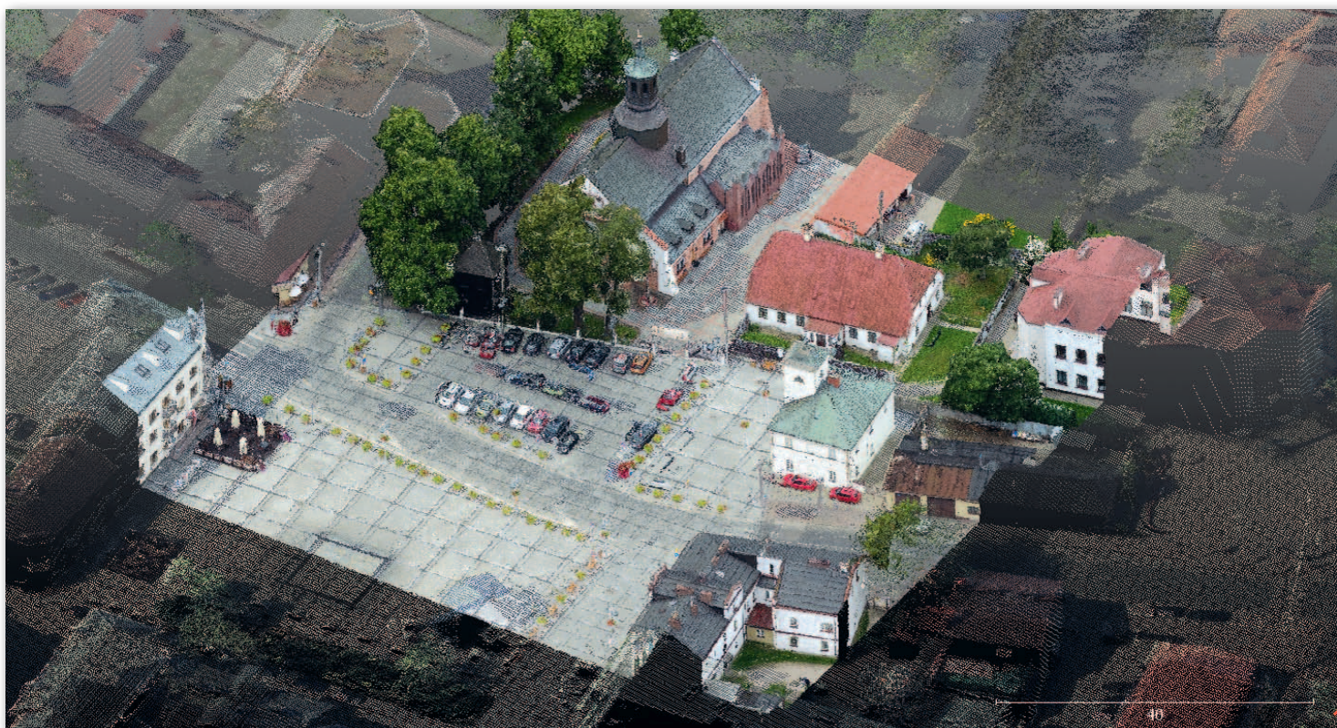
Rys. 3. Porównanie gęstości chmury punktów uzyskanej z danych z BSL (środek rysunku) oraz danych ALS
