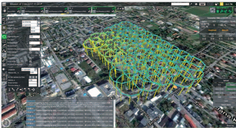
Rys. 2. Plan misji fotogrametrycznej w formie POI wykonanej w aplikacji UgCS
