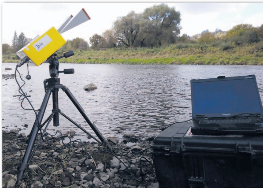
Fot. 2. Radar interferometryczny w trakcie pomiaru
