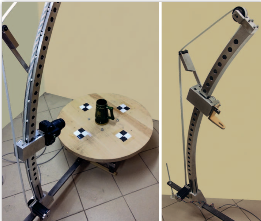
1. Po lewej: FocusSphere z aparatem Canon EOS 600D; po prawej: wysięgnik
