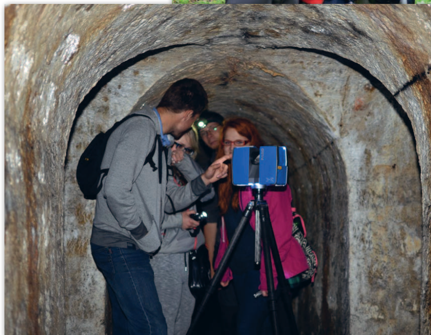
Pomiar skanerem Faro X330 w jednym z korytarzy minerskich
