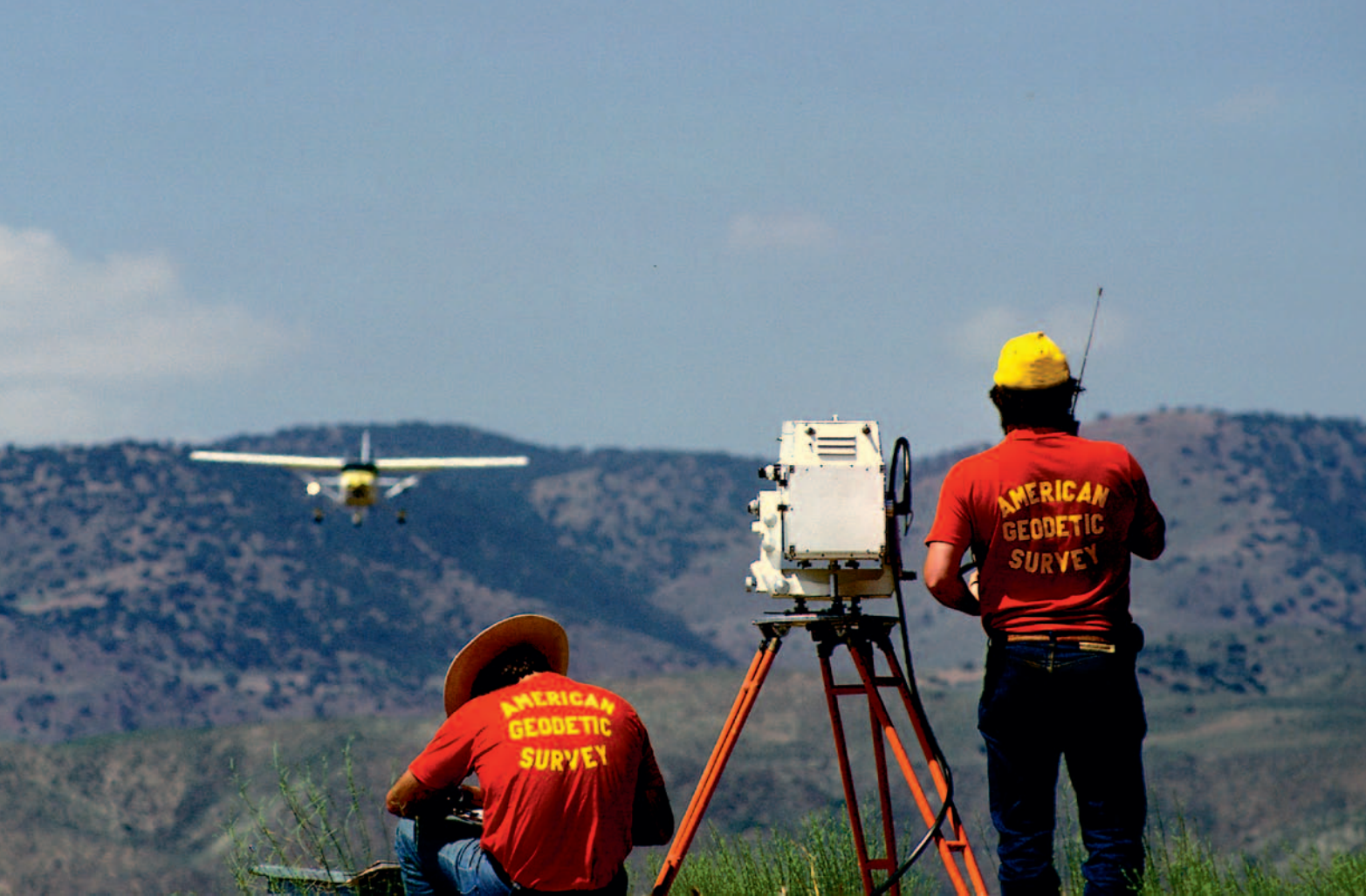
Pomiary uskoku San Andreas w Kalifornii, lata 80. Wzdłuż celowej samolot rejestruje parametry do wprowadzenia poprawki atmosferycznej
