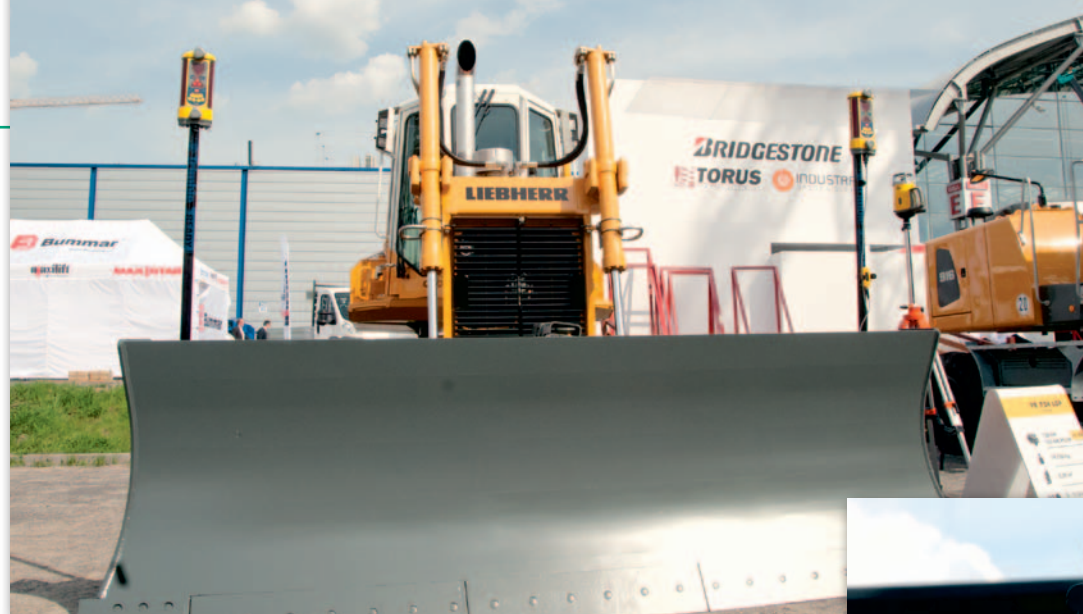
System sterowania spycharką 2D w ofercie firmy Trimtech
