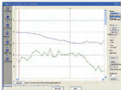
Pomiar echosondą dwuczęstotliwościową pozwala na monitorowanie dwóch obrazów dna zbiornika
