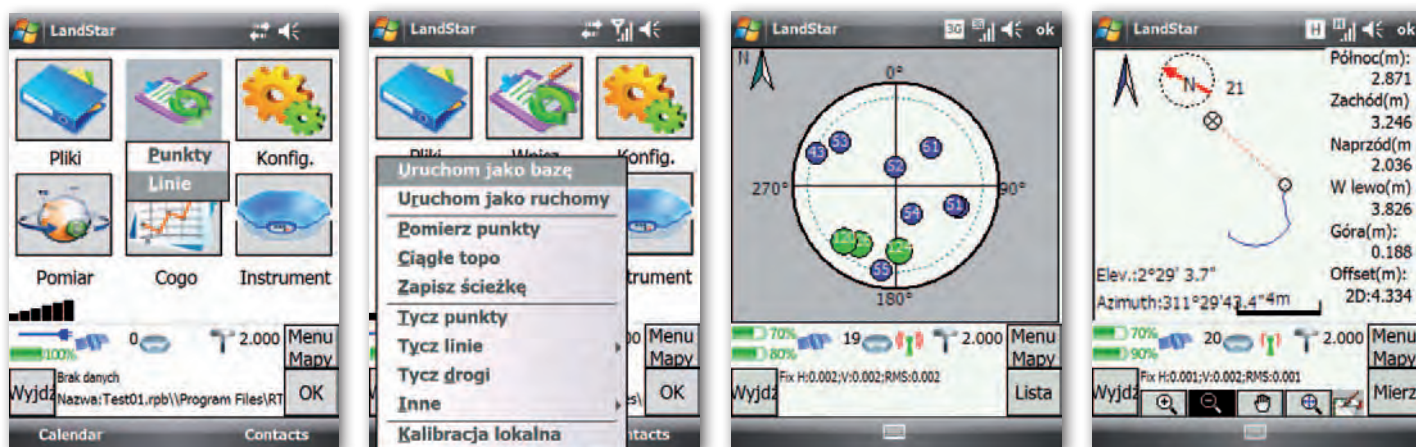
Widok menu, podgląd widocznych satelitów oraz ekran tyczenia w aplikacji LandStar
