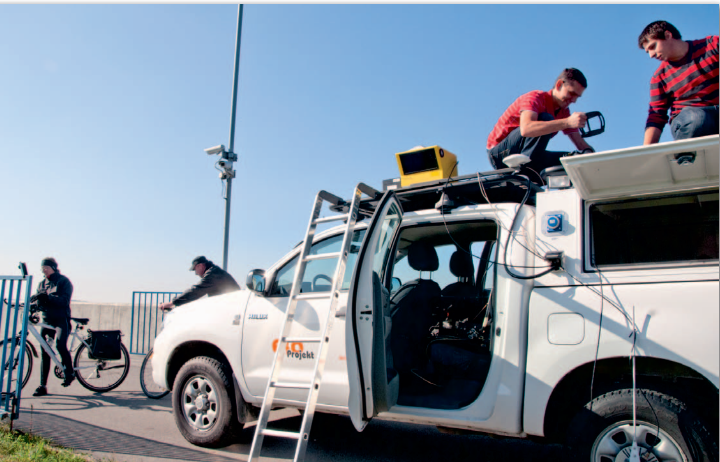
Montaż systemu w konfiguracji ze skanerem na dachu
