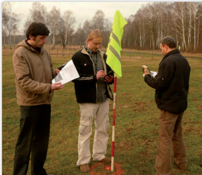
Pomiar punktów poligonu odbiornikami GPS klasy GIS
