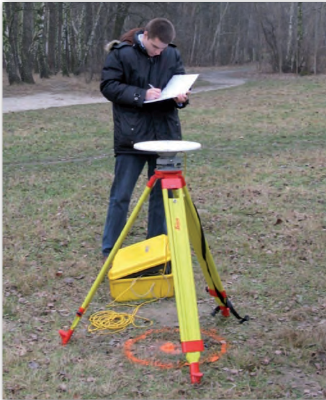
Pomiar statyczny GNSS na punktach poligonu
