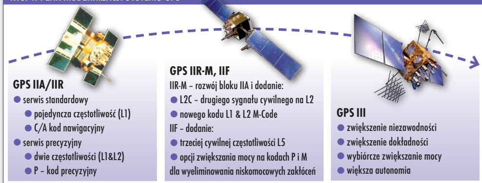
RYS. 1. PLAN MODERNIZACJI SYSTEMU GPS
