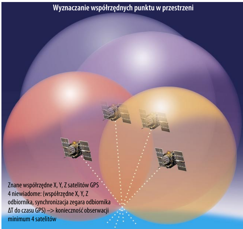
Rys. 4. Trysferacja (przestrzenne liniowe wcięcie wstecz) + obserwacja dodatkowa
