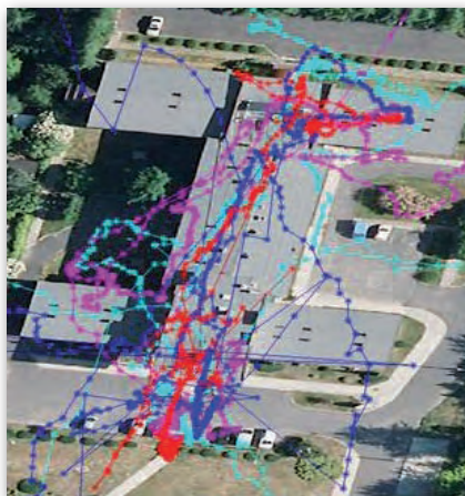
Rys. 12. Zestawienie czterech chipów GNSS podczas pomiaru wewnątrz budynku CBK PAN (czerwony: u-blox LEA 5H, granatowy: Sifir Star III, niebieski: Fastrax, różowy: MTK)
