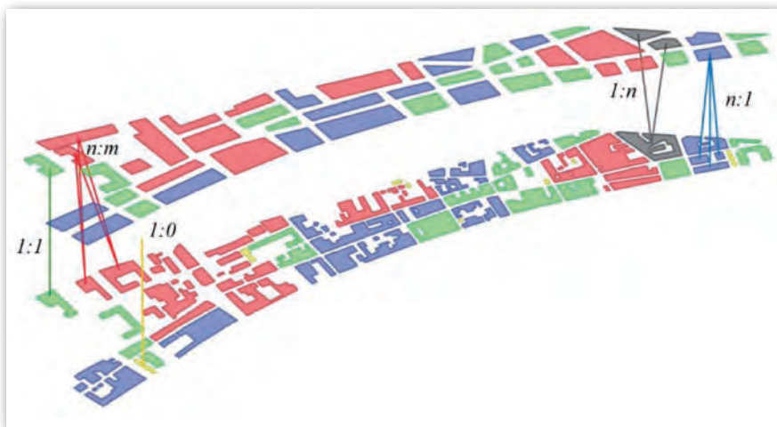
Rys. 3. Metodyka tworzenia wieloskalowej reprezentacji terenów zabudowanych w bazie danych typu MRDB [Burghardt]
