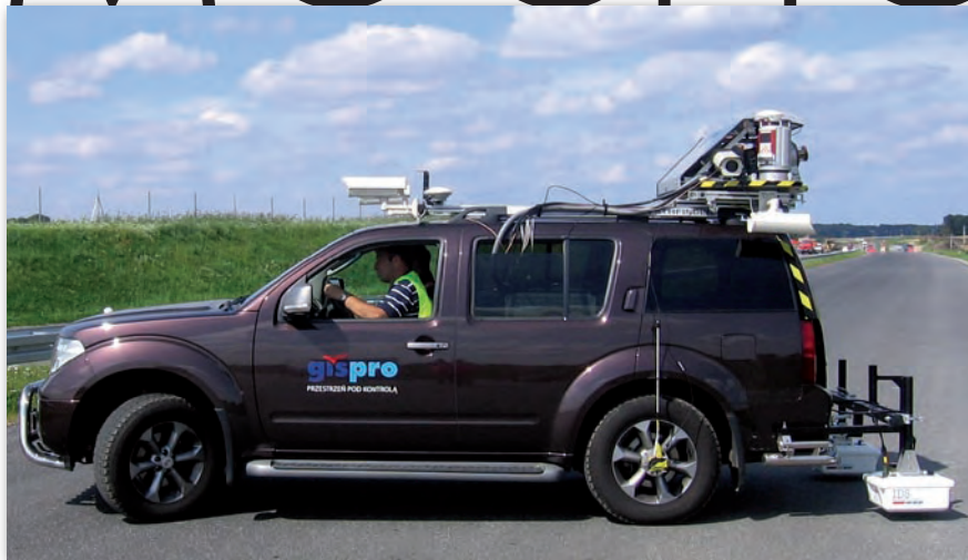
Rys. 1. System MMS/MLS firmy GISPRO
