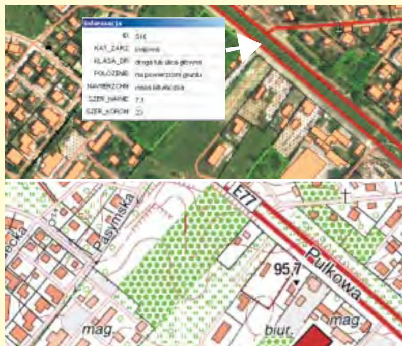
Rys. 1. Fragment Bazy Danych Topograficznych i opracowanej na jej podstawie mapy w standardzie TBD (model DLM i DCM)
