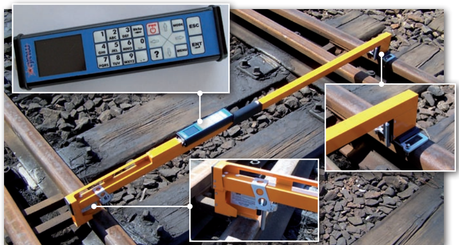
Rys 4. Podstawowe elementy toromierza DTG firmy GRAW: stopka lewa – ruchoma, stopka prawa – stała, rejestrator
