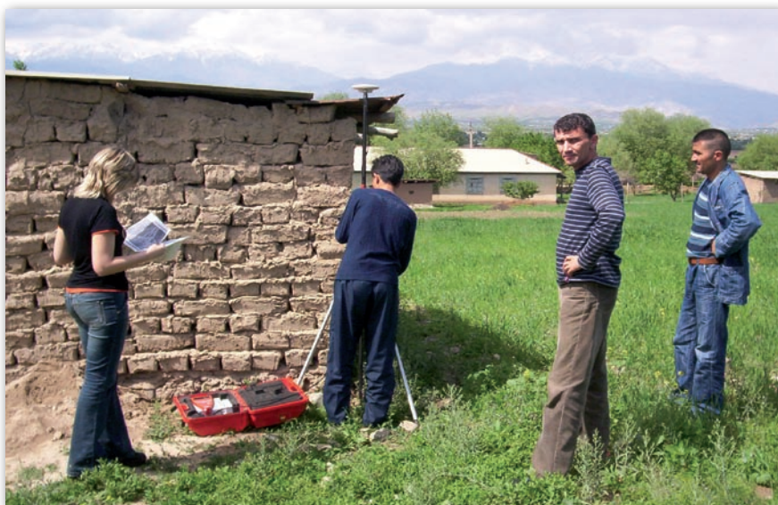
Pomiar współrzędnych punktów kontrolnych metodą GPS
