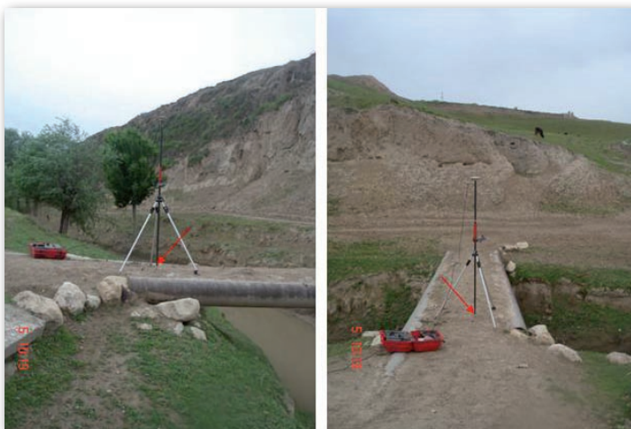
Wyznaczanie współrzędnych fotopunktów na moście
