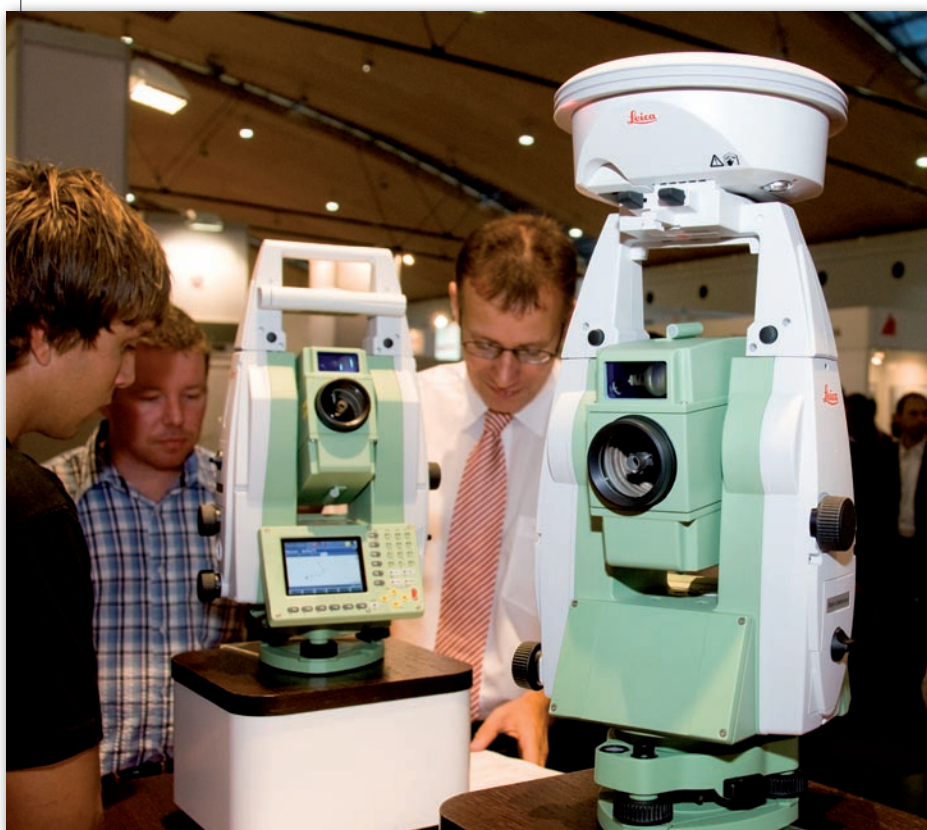
Leica SmartStation, czyli tachimetr Viva wraz z odbiornikiem GS15
