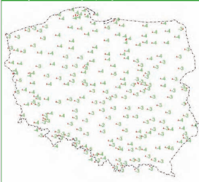
RYS. 2. WARTOŚCI RUCHÓW PIONOWYCH W WĘZŁACH SIECI [mm/rok]
