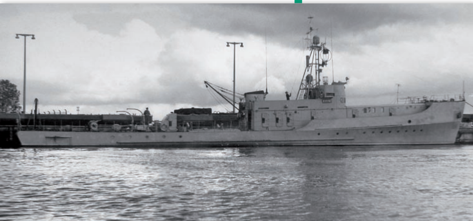
OH „Kompas” w porcie wojennym w Gdyni. Okręt miał 300 ton wyporności, wymiary 45,7 x 5,5 m, zanurzenie 2,2 m, prędkość maksymalną 14 węzłów i 38 osób załogi
