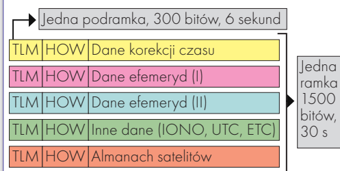
RYS. 9. BUDOWA DEPEZY NAWIGACYJNEJ GPS
