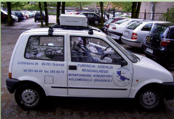
Rys. 1. Urządzenie pomiarowe zamontowane na dachu samochodu
