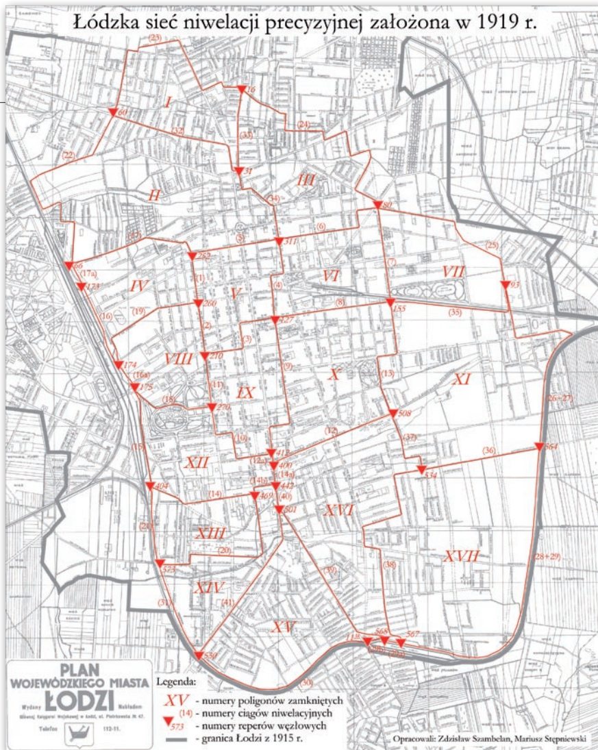
Szkic ciągów i reperów węzłowych niwelacji precyzyjnej wykonanej w 1919 r.
