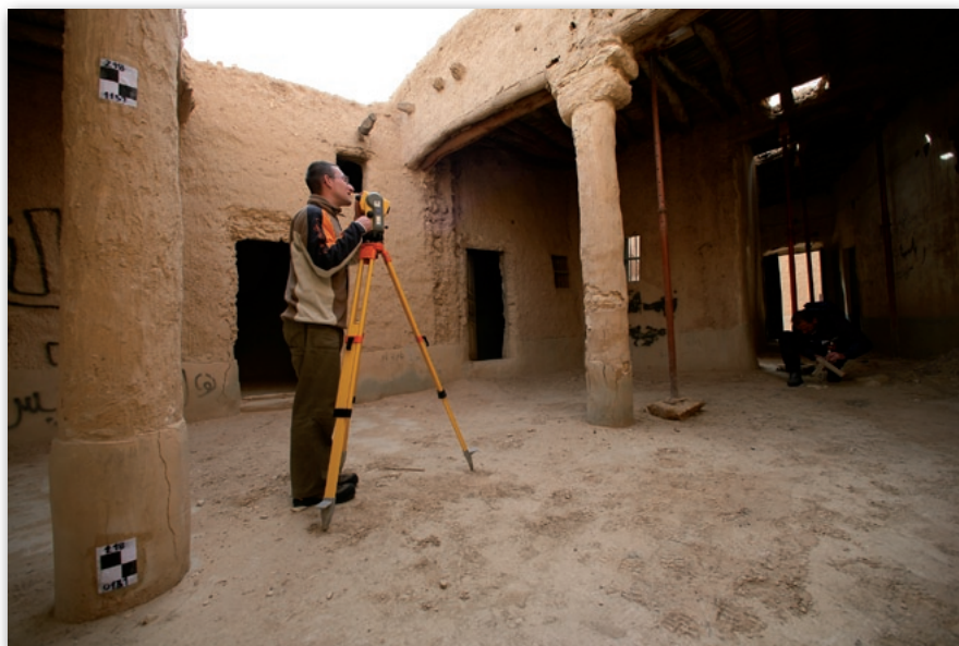
Współrzędne 13 000 punktów łącznych do skanowania pomierzono tachimetrami elektronicznymi
