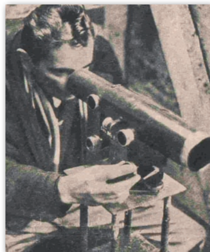
Inżynier Jerzy Fellmann obsługuje niwelator precyzyjny, wskazujący ewentualne odkształcenia podłoża z dokładnością 0,1 mm
