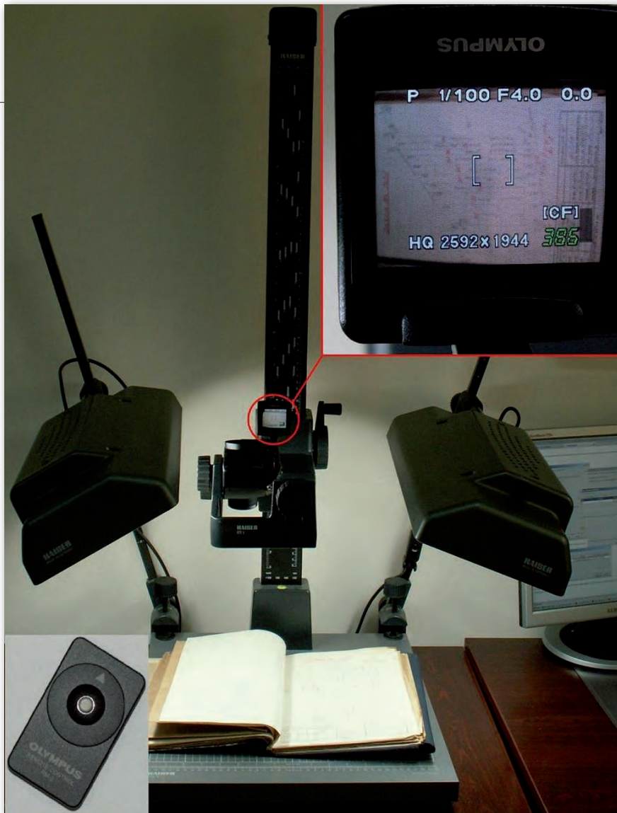
Rys. 2. Zestaw do fotografowania dokumentacji zastosowany w Powiatowym Ośrodku Dokumentacji Geodezyjnej i Kartograficznej w Wołominie
