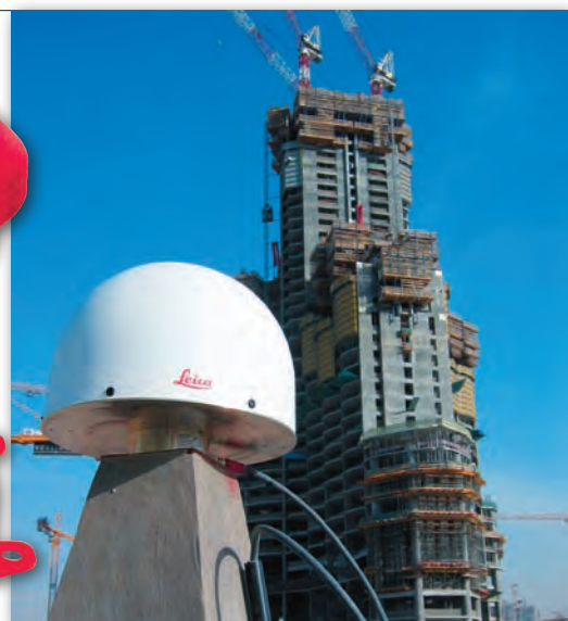
Rys. 3. Odbiorniki GPS/GNSS serii GMX900 w zastosowaniach monitoringu strukturalnego
