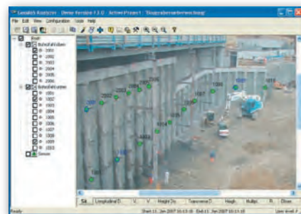
Rys. 2. Widok okien dialogowych modułów GeoMoS Monitor, Analyzer oraz Site Map
