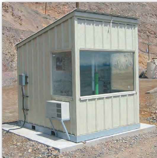
Rys. 4. Kontener pomiarowy oraz zmotoryzowana stacja tachimetryczna TCA2003
