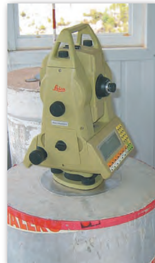
Rys. 4. Kontener pomiarowy oraz zmotoryzowana stacja tachimetryczna TCA2003
